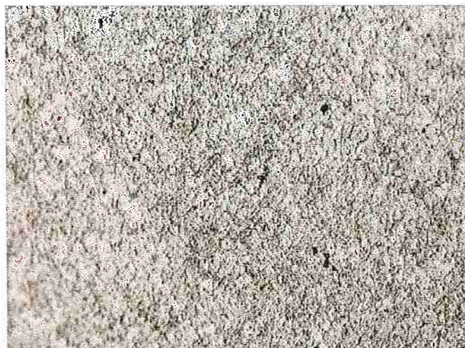
Figura 16 - Permanência no banho: 13min. Nital: 20s
