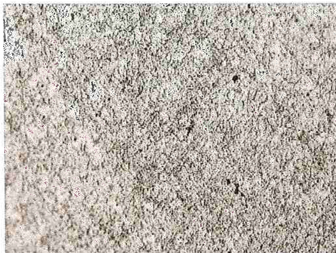
Figura 16 - Permanência no banho: 13min. Nital: 20s
