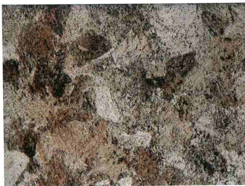
Figura 3 - Estrutura bruta de laminação do aço usado. Aumento: 1000x; ataque: nital
