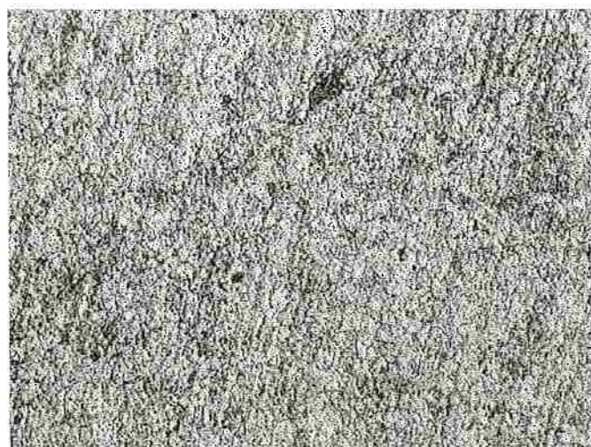
Figura 18 - Permanência no banho: 17min. Nital: 20s
